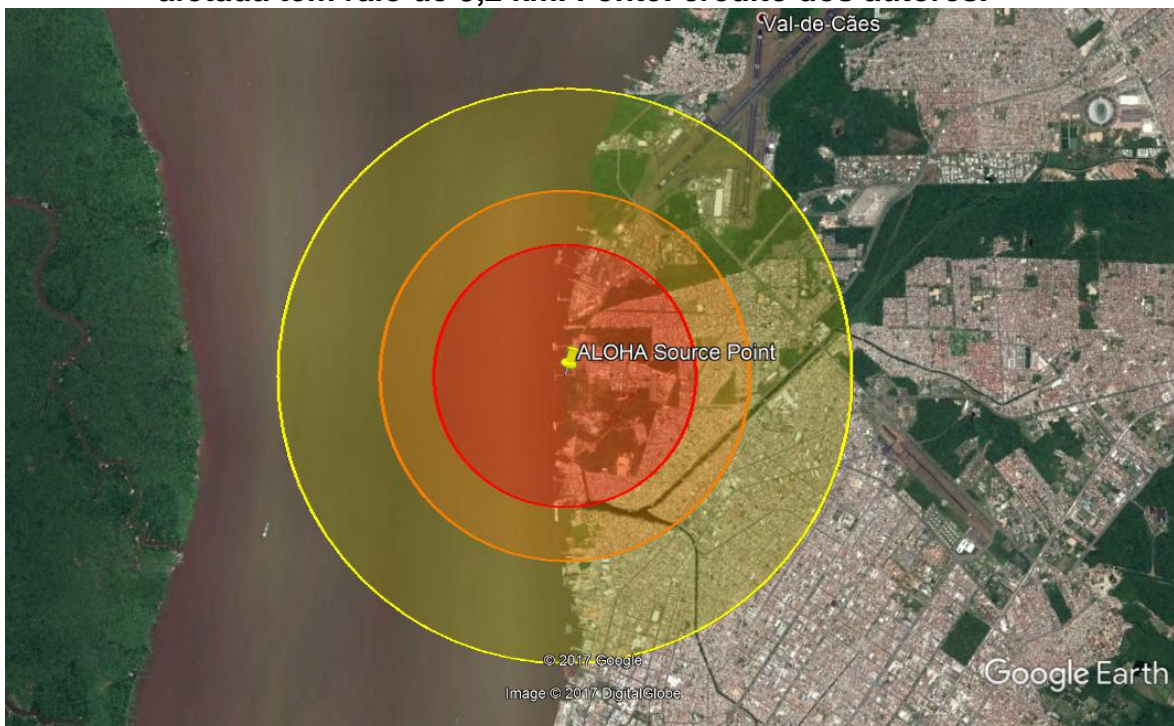
Fig.6. Fenômeno BLEVE para o Terminal da Miramar (Belém do Para). O círculo da maior área afetada tem raio de 3 km. Fonte: TORRES et al. 2012.
