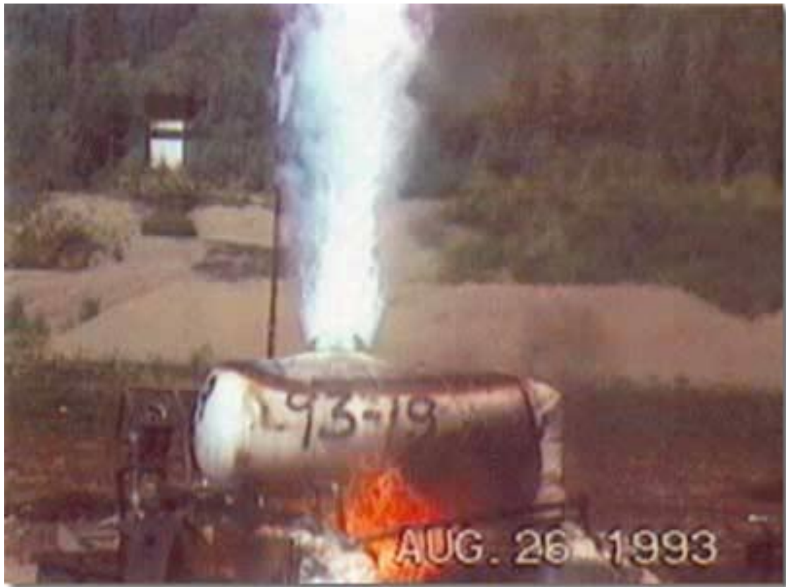
Fig.2. Ruptura de um tanque de gás. Fonte: http://www.cetesb.sp.gov.br/emergencia/artigos/artigos/bleve.pdf
